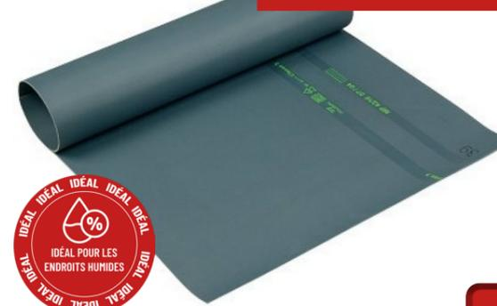
Tapis isolant en élastomère pour travaux sous tension et hors tension. Utilisable lors des défibrillations. Il possède un motif antidérapant sur les deux faces et il permet l'isolation de l'opérateur du potentiel terre. Il est sans halogène pour plus de sécurité en cas d'incendie. Composé sans plomb, mercure, Damium, Chrome, PBB et PBDE. Notre tapis isolant est conforme RoHS2, REACH, conforme à la norme internationale IEC 61111 et il s'agit d'un dispositif de classe 2C.
